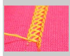
*Links:* Bei Zug löst sich der Greiferfaden aus der Schlinge des orangen Nadelfadens.
