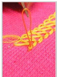
Links: Mit einer Nadel können sie in die Schlinge des orangen Nadelfadens einstechen und dann die Schinge höher ziehen, bis das Ende des Nadelfadens durch die Schlinge des Greiferfadens geschlüpft ist und das Fadenende lose hängt.
