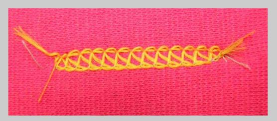
Links der Nahtanfang, der nicht von selbst aufgeht, rechts das gesicherte Nahtende der Covernaht von unten gesehen
