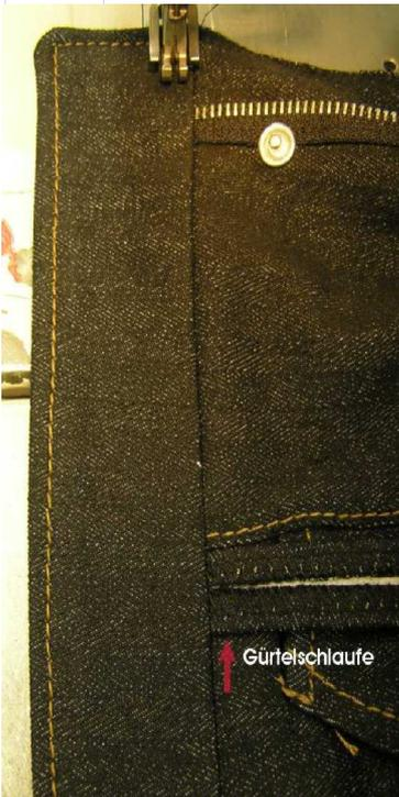
Am besten fangen sie mit dem **Absteppen** am offenen, hinteren Ende des Bundes an, nähen vorne 2 mal um die Ecke und nähen bis zum Ende des Bundteiles weiter. Wenn die Teile gut vorgebügelt wurden, legen sie sich fast von selbst.
