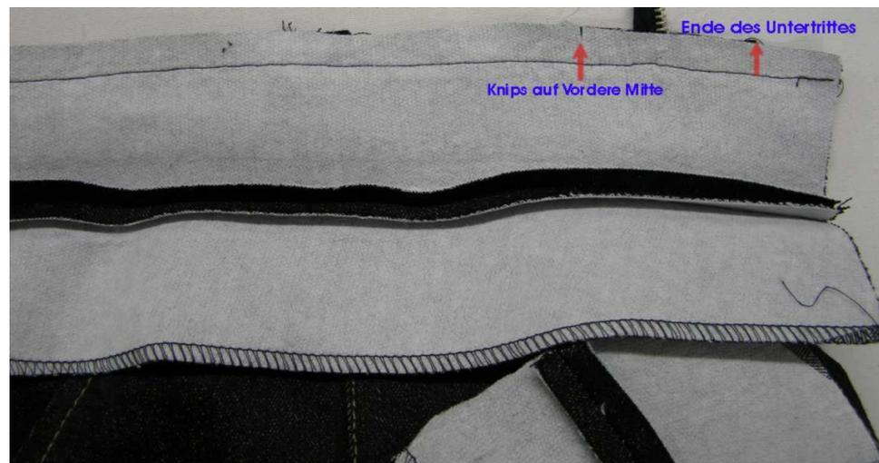
Zum **Verstürzen** an den **Bundenden** das innere, untere Bundende etwas umschlagen und mit festnähen. **Gerade abnähen**, die obere **Ecke abschneiden, wenden** und die **Ecke** mit einem Hilfsmittel wie Schraubenzieher oder Schere **rausdrücken**.
